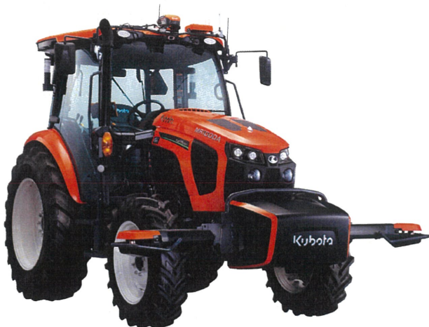
導入した Agri Robo MR1000AH 機体前方の展開式センサースターが特徴です
