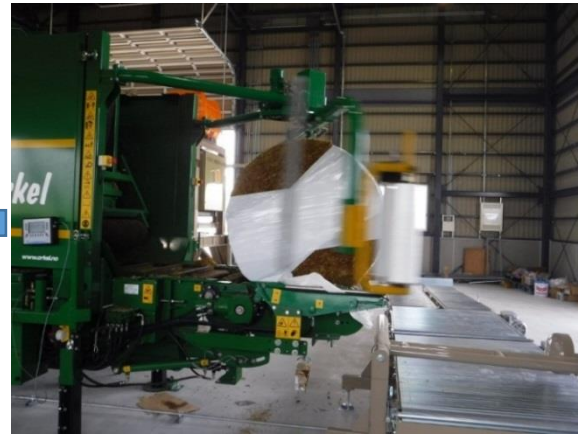
⑥ラッピング後、計量すると製品シールが出てくる
