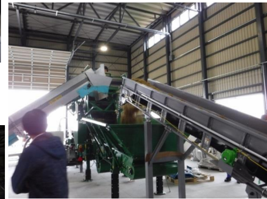
④マルチコンパクターへ商品がコンベア移動する
