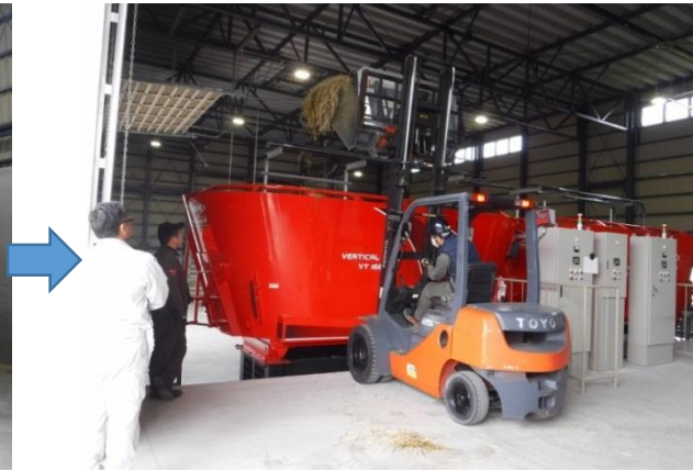
②ミキサーへ原材料を投入する
