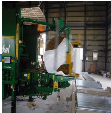
⑥ラッピング後、計量すると製品シールが出てくる
