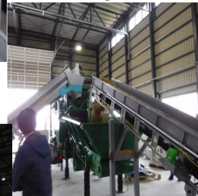
④マルチコンパクターへ商品がコンベア移動する
